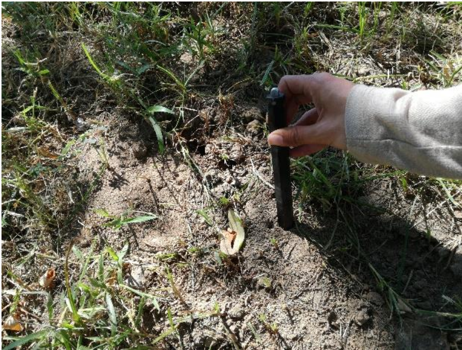
Figura 148 Toma de parámetros geomecánicos de suelo transportado de ambiente fluvial en el municipio de Mompós
