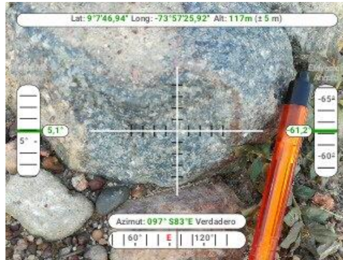
Figura 64 Granodioritas con meteorización esferooidal en el Cerro El Cabrito (Coordenadas 9.12974N, -73,45763W)
