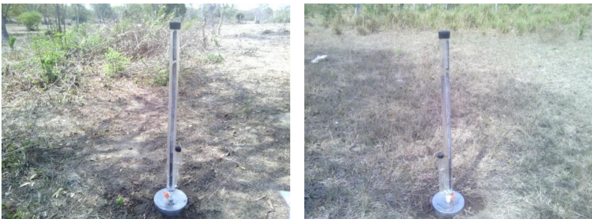
Figura 299 Equipo para determinar la infiltración en el suelo en campo.
