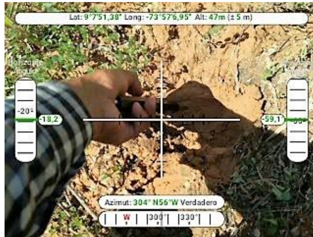
Figura 118 Medición de parámetros geomecánicos con penetrómetro en suelo residual de la Formación Noreán. (Coordenadas 9,13099N, -73,95211W)
