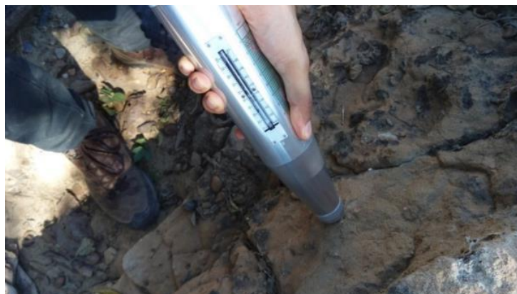
Figura 128 Medición Geomecánicas con el esclerómetro en areniscas fosilíferas de la Formación Betulia. Municipio de San Sebastián de Buena Vista. (9.471563,-74.67090)
