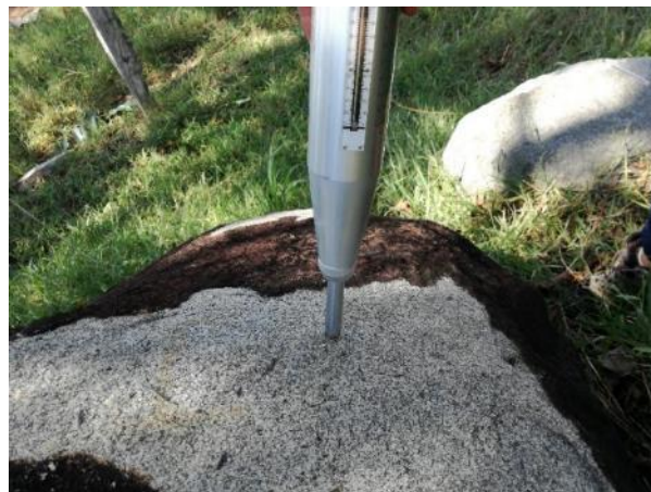
Figura 117 Toma de parámetros geotécnicos en Neis de San Lucas en la vía Hatillo de Loba- El Banco, Magdalena (Coordenadas 8,970257N, -74,052719W)
